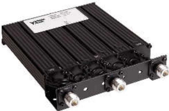
Duplexeur Procomm UHF. Ils sont constitués de 6 cavités coupe bande, 3 sur la fréquence basse, 3 sur la fréquence haute. Ils disposent de 3 connecteurs. Le connecteur central est l'antenne, le connecteur gauche est la fréquence basse, le connecteur droit est la fréquence haute. La syntonisation est réalisée à l'arrière sur chacune des cavités constituant le duplexeur. Les boucles ne sont pas démontables.
