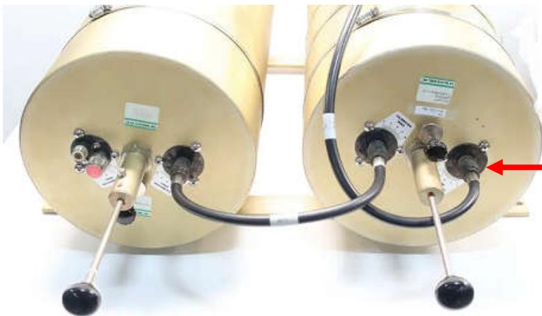
Connecteur N. Le socle comporte une boucle plongeant dans la cavité. On peut changer la boucle pour un autre type, ce qui change la courbe de réponse de la cavité (passe bande, coupe bande, coupe passe etc)
