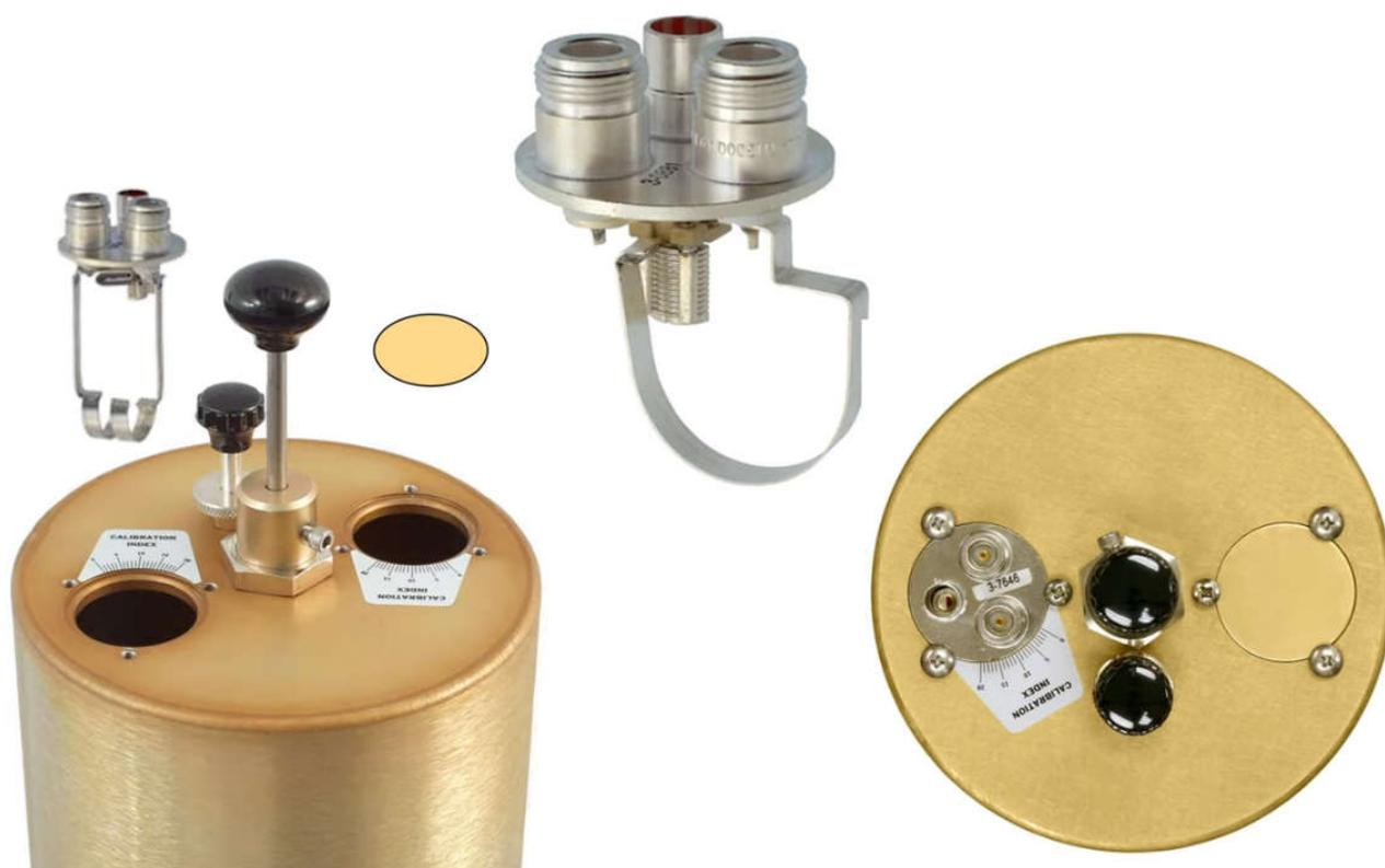
Mode coupe bande sur une cavité Tx-Rx systems. On positionne une boucle notch dans le premier port de la cavité. On place un obturateur sur le 2<sup>ème</sup> port de la cavité. Pour ajuster la réponse de la cavité, on tourne les boucles et on règle le condensateur de la boucle.
