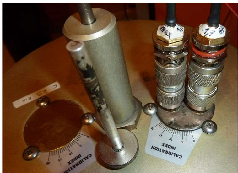
La cavité est la même, mais on a utilisé une boucle "notch" comprenant deux ports (entrée, sortie) sur un signal dont on veut couper une fréquence.
