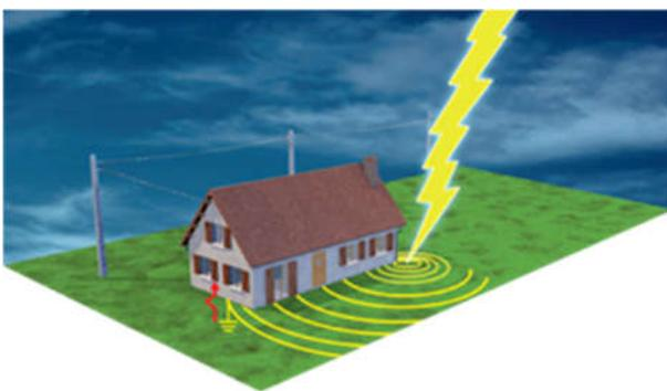
Lors d'un coup de foudre, une surtension peut être remontée par la terre. Cela peut être en partie réglé par des liaisons équipotentielles des structures métalliques aux masses et des terres de l'ensemble de l'installation d'une structure ainsi que par une protection contre les surtensions installée sur les services.
