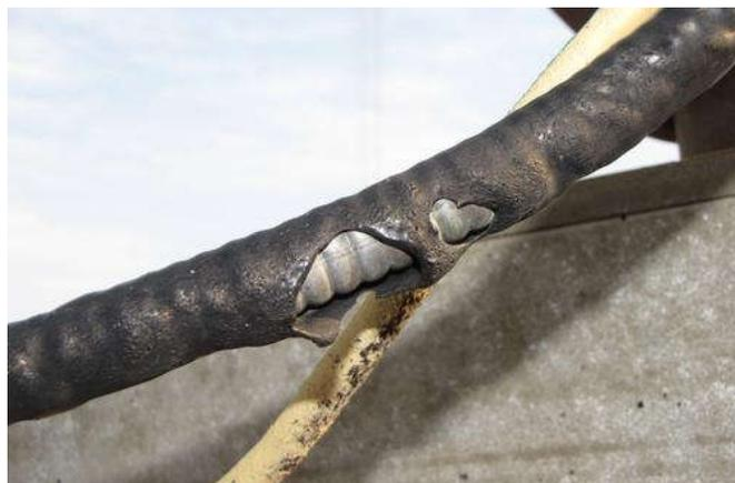
Tableau électrique volatilisé par la foudre câble coaxial détruit après un coup de foudre non écoulé
