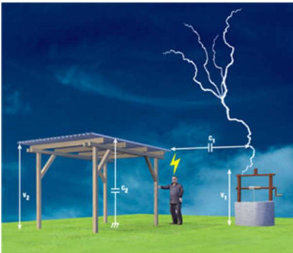
La résistivité des sols fait que les prises de terre sont résistantes. De ce fait, lors du passage d'un courant de foudre, une montée brutale en potentiel apparaît. Aussi se crée-t-il des différences de potentiels entre certains éléments métalliques. D'où l'intérêt de prendre un soin particulier à la réalisation des prises de terre et à la liaison des masses métalliques jouxtant les descentes.
